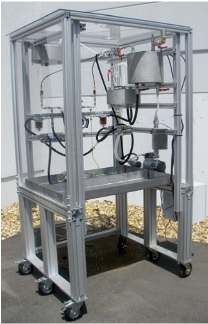
3 Prüfstand zur Untersuchung der Auswirkung dynamischer Druckabsenkungen auf das Entstehen von Kraftstoffdampfblasen
