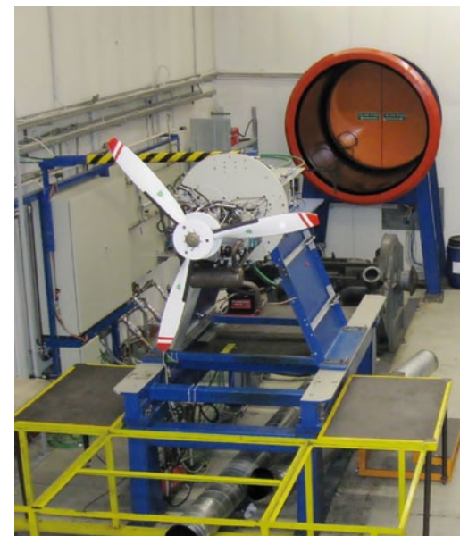
5 Propellerbestückter Rotax 912 ULS auf dem Prüfstand
